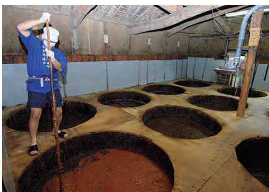
桶に仕込んだ麴を攪拌します
