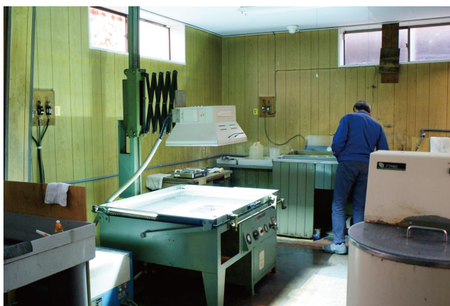
亜鉛版のほかに樹脂版にも対応。樹脂版にUVを使い、版を硬化させる作業。
