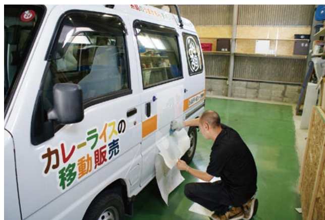
ステッカー施工の様子。
