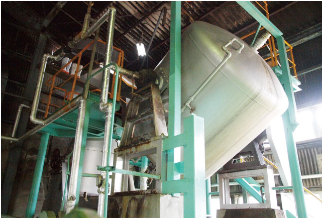
種こうじを付け、室(むろ)という機械の中で発酵させていきます
