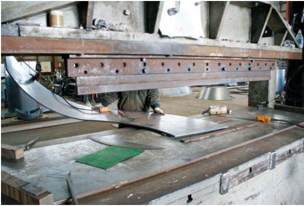
油圧プレス機による加工の様子
