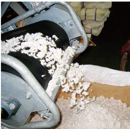
紙おむつから取り出された上質パルプ。写真はバラ状に加工されたパルプで防火板等の原料となります。
